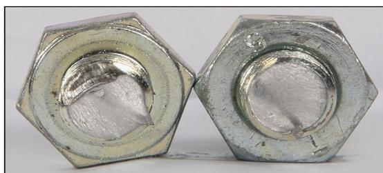
Gambar 19. Permukaan Baut Galvanis Posisi 5
