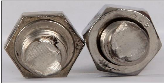
Gambar 10. Permukaan Baut Stainless steel Posisi 2.
