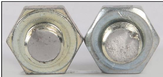
Gambar 18. Permukaan Baut Galvanis Posisi 4
